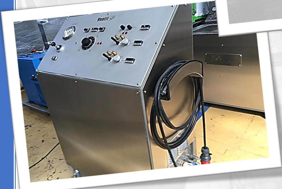
**Le contrôleur d'actionneurs** permet le réglage des motorisations permettant les manœuvres d'ouverture/fermeture des vannes en hydraulique, pneumatique et électrique.
